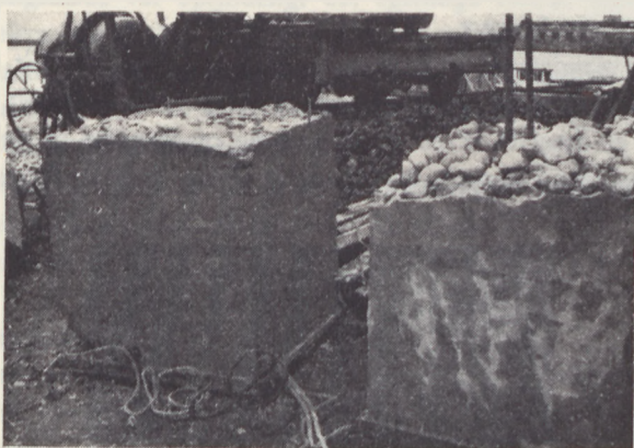
Fig. 11. 2 blokke udstøbt under vand med forbedret mørtel gennem rør placeret i singels.
