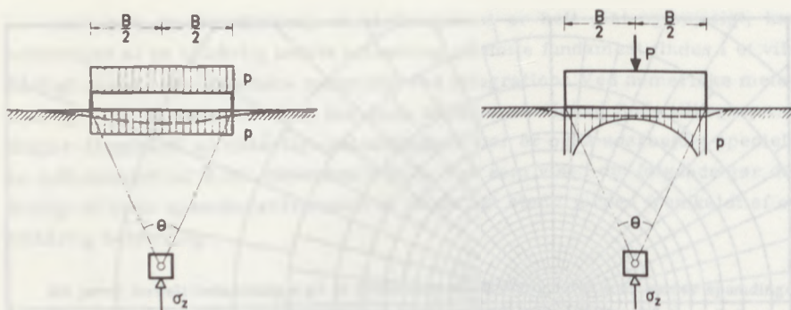
Figur 7.3 Slapt fundament med ensformigt fordelt belastning og centralt påvirket, stift fundament.
