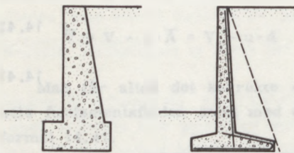
Figur 14.15 Grovbeton- og jernbetonstøttemur.
