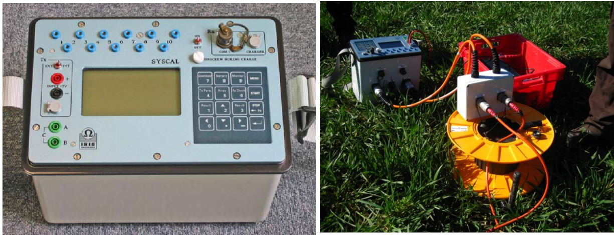
Figur 14, (TV) Syscal Pro Switch 72 instrumented. (TH) Opstilling af udstyret i felten. Syscal forbundet til switchboks.
